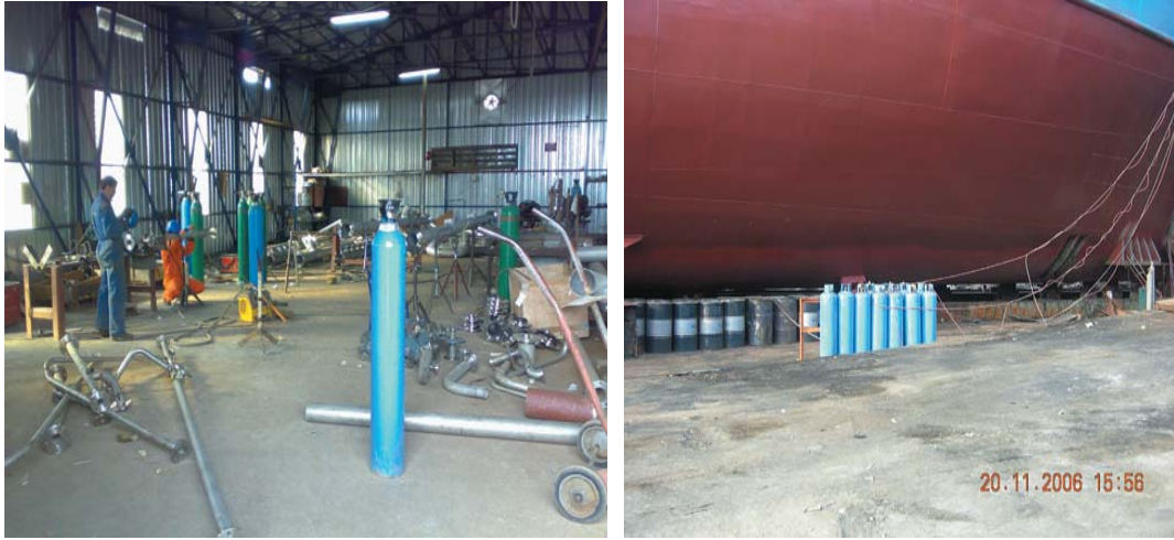
Resim 6.1.7. Gaz Tüplerin Uygunsuz Şekilde Depolanması ve Taşınması
