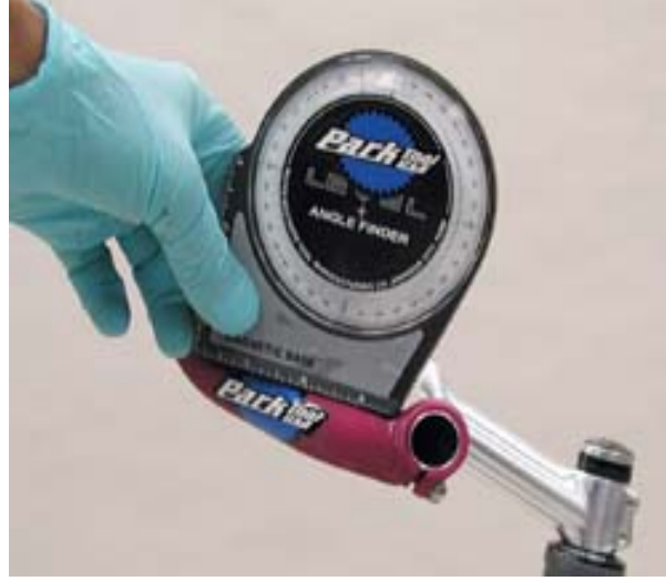
Şekil 3.36. Gidon Eğim Oranı ve Açısının Ölçümü
