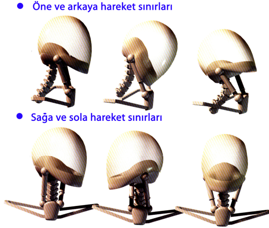
Şekil 3.7. Kafa Hareketlerinin Mekanik Anlatımı
