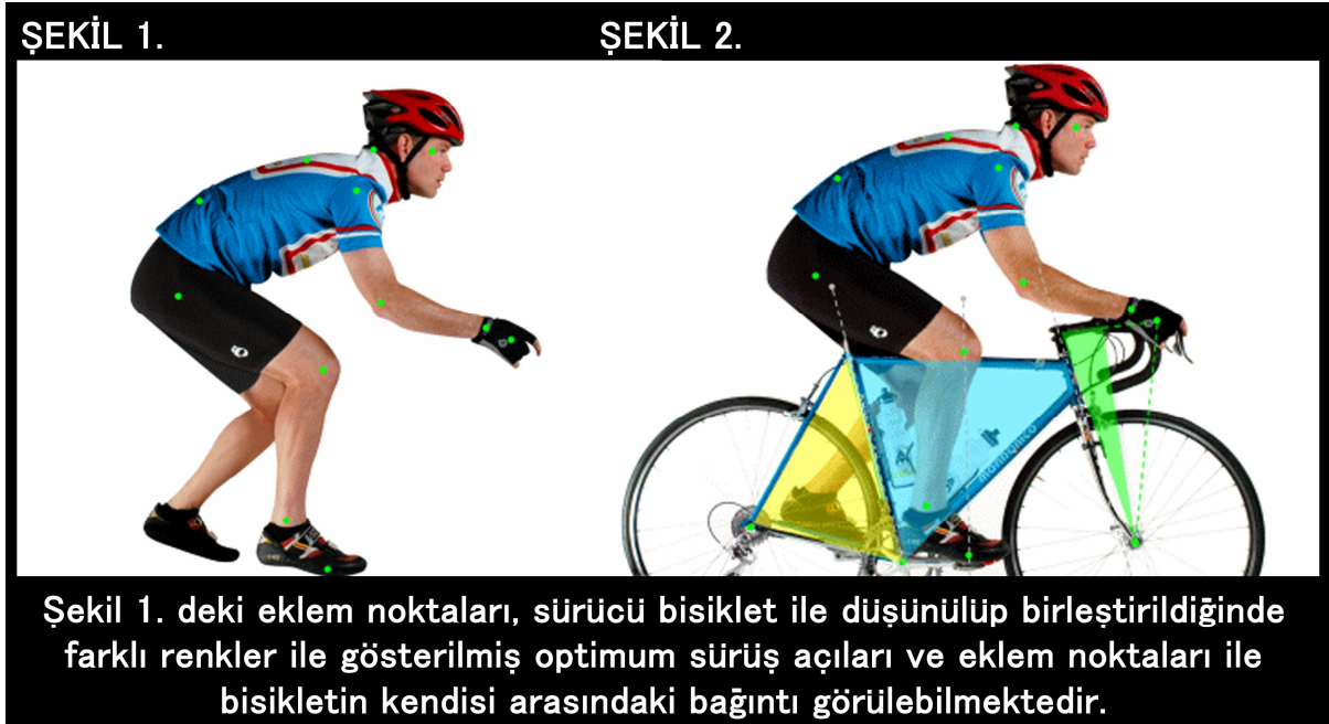
Şekil 3.30. Sürücü Eklem Bağlantı Noktalarının Bisiklet ile Bağlantı Şeması www.smartcycles.com
